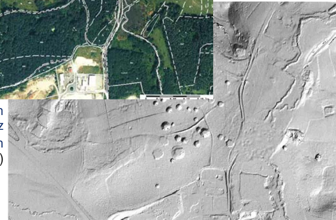
Bergschaden auf dem Sportplatz von Kupferberg (Ofr.) - Der Bruch auf dem St. Veits-Schacht ist rund 30 Meter tief Quelle: StMWIVT
